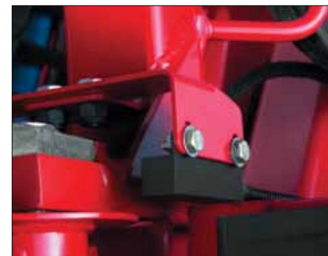
Sensor do sistema de centralização automática das barras
