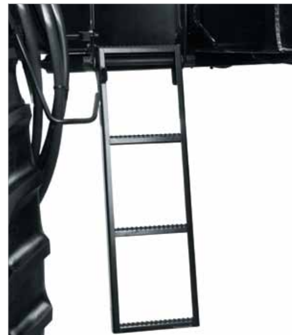
Escada de acesso ao motor
