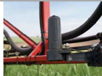
Sensor automático de altura
